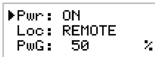
Da questo menù l'utente può attivare o disattivare l'erogazione di potenza, impostare il controllo "Locale" o "Remoto" e impostare la percentuale di potenza di **Power Good**.
