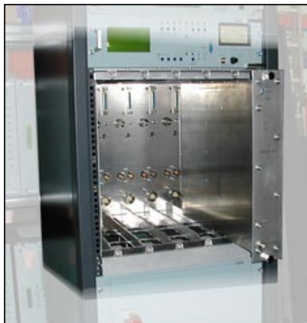
Figura 5-2 Inserimento di un modulo RF
